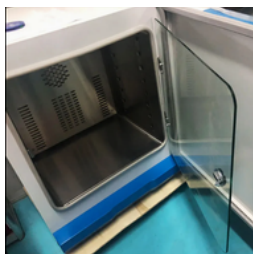
Doble puerta tipo D: permite visualizar sin perder estabilidad térmica.
