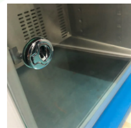
Puerta con cierre seguro: mantiene la estabilidad térmica interna.
